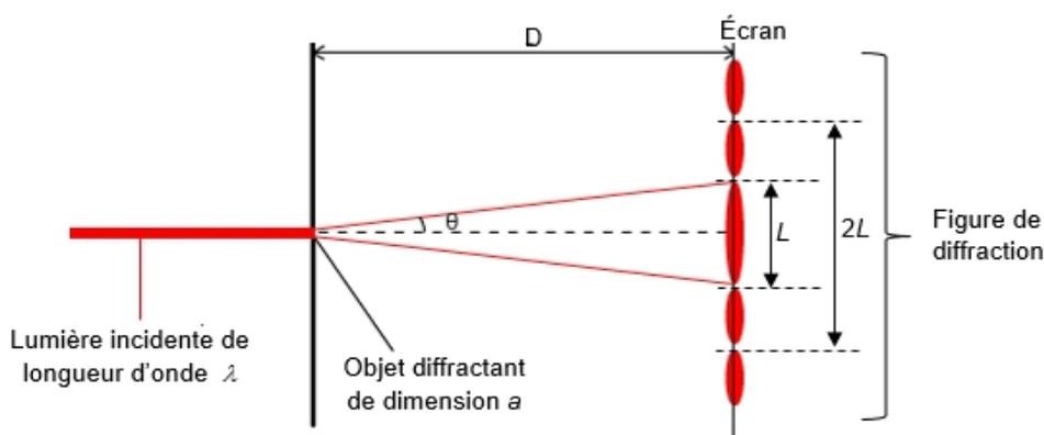
**Schéma en vue de dessus du montage d'une expérience de diffraction**
