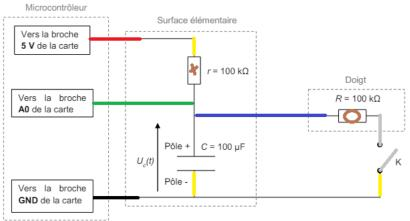
Il est impératif de respecter la polarité du condensateur électrolytique lors de son branchement dans le circuit.
