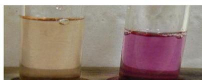
**Description :** J'observe que le rouge de crésol est de couleur violet, dans le cas du dégazage à température très basse (0°C) ; et jaune à température élevée (70°C). On constate que plus l'eau gazifiée est placée à température élevée, plus le volume de CO<sub>2</sub> dégazé est important à l'issue de l'expérience.
