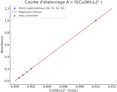
Déterminer valeur de concentration en quantité de matière  $[Cu(NH_3)_4^{2+}(aq)]$  de la solution  $S_{eau}$  à l'aide de la courbe d'étalonnage  $A = f([Cu(NH_3)_4^{2+}(aq)])$
