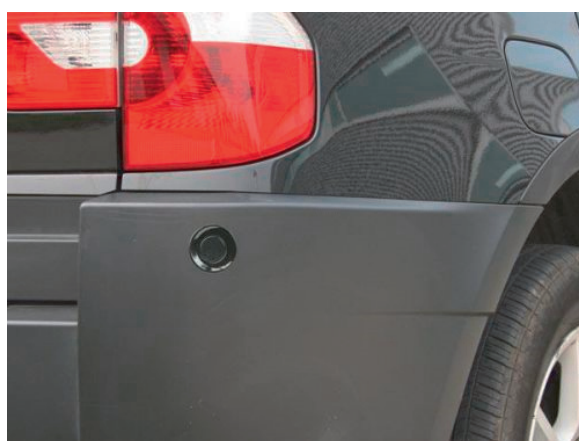
Radar de recul sur une automobile
